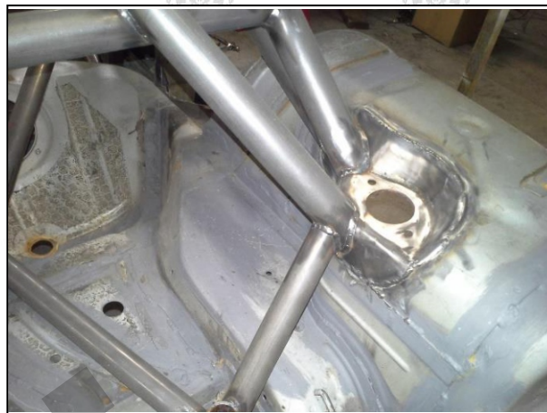
RÖGZÍTÉS AZ ELSŐ FUTÓMŰ TORONYHOZ ATTACHMENT TO FRONT SUSPENSION
