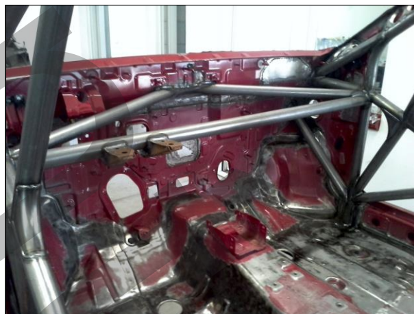
FŐÍV RÖGZÍTÉSE A "B" OSZLOPHOZ MAIN ROLLBAR TO "B" PILLAR ATTACHMENT
