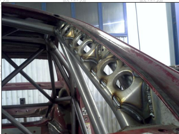
ELSŐ-/OLDALÍV RÖGZÍTÉSE AZ "A" OSZLOPHOZ FRONT ROLLBAR TO "A" PILLAR ATTACHMENT
