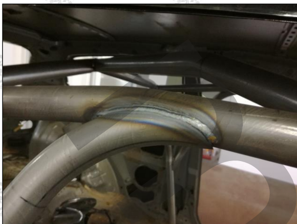
PHOTO 19 A BUKÓKETREC BEÉPÍTÉS UTÁN NEM LÁTHATÓ RÉSZEI NOT VISIBLE DETAILS OF CAGE
