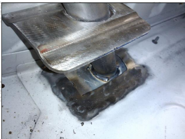
A BUKÓKETREC BEÉPÍTÉS UTÁN NEM LÁTHATÓ RÉSZEI NOT VISIBLE DETAILS OF CAGE
