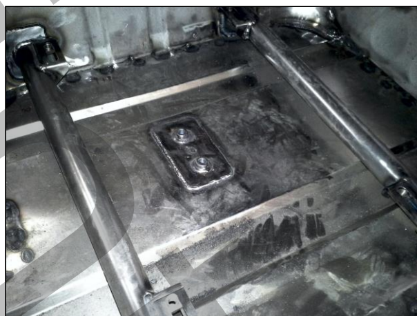
PHOTO 32 HEGESZTETT ÜLÉSTARTÓ - NAVIGÁTOR WELDED SEAT MOUNTING - CO DRIVER
